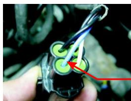
Провод „Ip“ (цвет КРАСНЫЙ) подключен к контактному выводу номер 4 в контакте.
