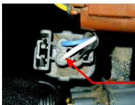
Провод „Ip“ (цвет БЕЛЫЙ) подключен к контактному выводу с обозначением “+”
